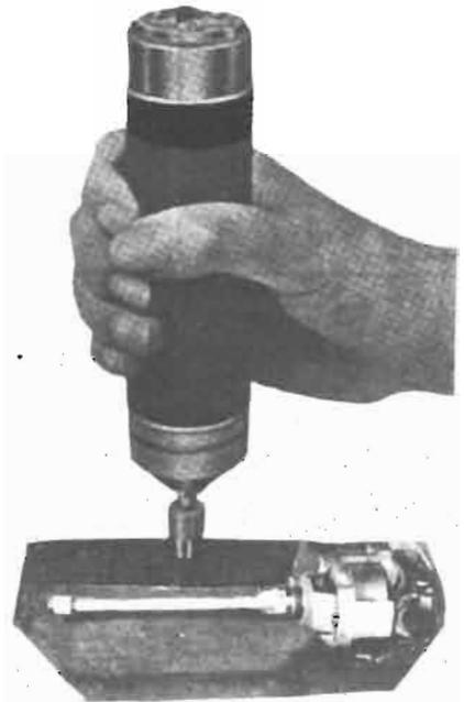
Fig. 5 - Trapano a pila, con punta da 1 mm per schede, realizzazione di IOSKK.
